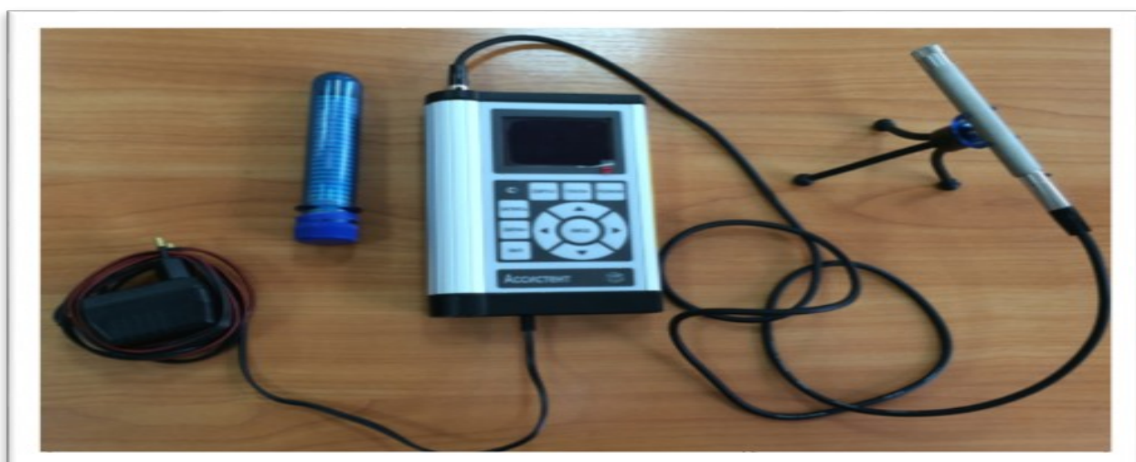
Рисунок 4 - Анализатор шума и вибрации «АССИСТЕНТ».
