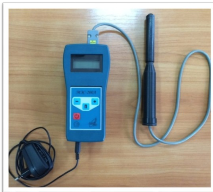
Рисунок 1 - Измеритель параметров микроклимата МЕТЕОСКОП-М.
