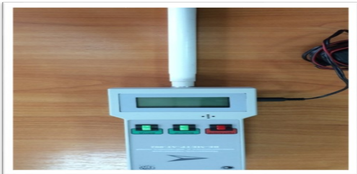
Рисунок 2 - ВЕ-метр-АТ-002 Измеритель параметров электрического и магнитного полей.
