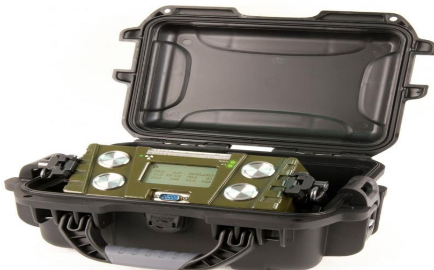
Рисунок 29 - Универсальный прибор радиационной и химической разведки ПРХР-500
