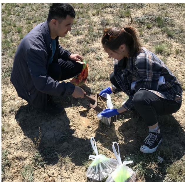
13 сурет – Оқу орнының аумағындағы топырақтың беткі үлгісін алу
