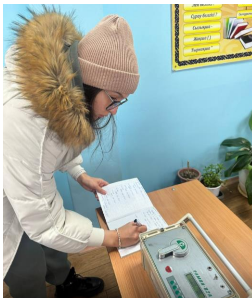
11 сурет – Ақсу ауылындағы орта мектептің ішінде радонның эквивалентті тепе-теңдік көлемдік белсенділігінің мөлшерін өлшеу, Бк/м 3
