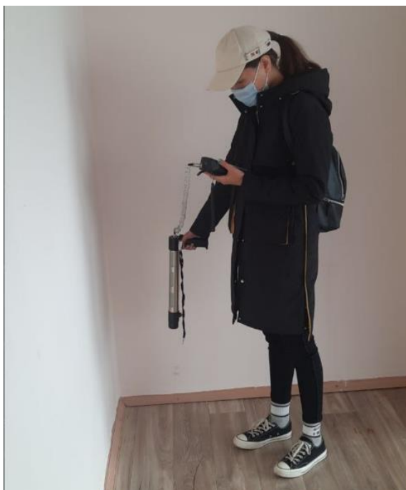
7 сурет – Жалпы білім беретін мектептің бір кабинетіндегі гамма-сәулелерінің амбиентті эквивалентінің доза қуатын өлшеу
