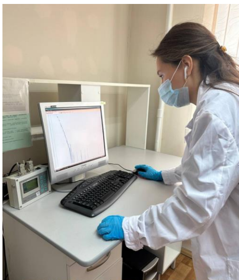
10 сурет – Ақсу ауылындағы мектеп аумағында алынған топырақ үлгілерін «Прогресс-БГ» спектрометриялық кешенінде өлшеу
