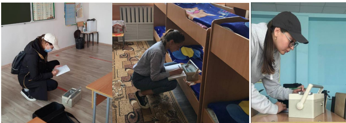
16 сурет – Ақсу ауылындағы мектепте радонның эквивалентті тепе-теңдік көлемдік белсенділігін өлшеу
