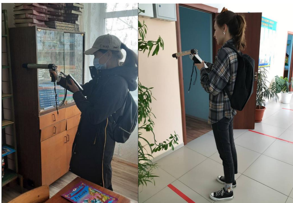
12 сурет – Мектеп ғимаратының гамма түсірілімдерін жүргізу
