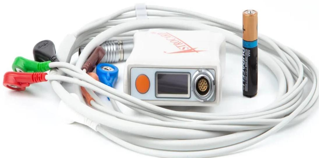
Рисунок 13 – Амбулаторный портативный суточный регистратор ЭКГ по Холтеру - Astro Card
