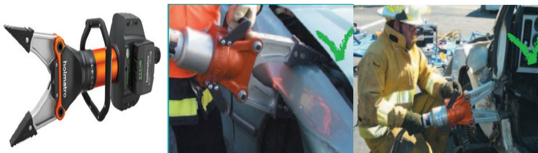
Рисунок 12 - Расширитель Holmatro, используемый бригадой ТМСП.
