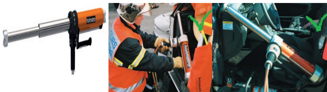
Рисунок 14 - Домкрат Holmatro, используемый бригадой ТМСП.
