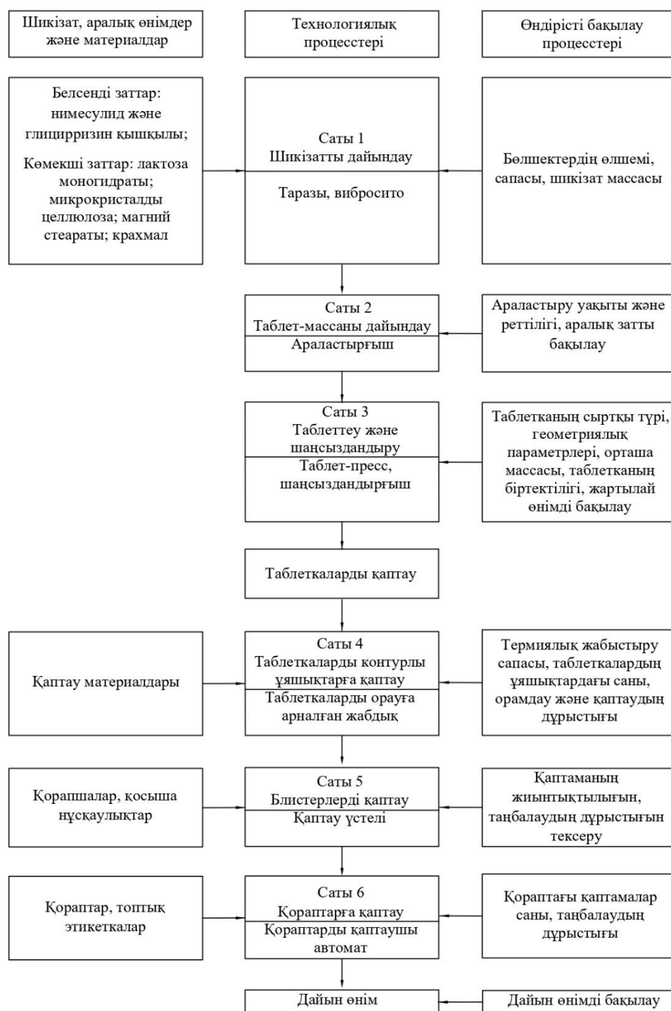
6-сурет – НМС және ГҚ негізіндегі таблеткаларды алу технологиясының сызбасы
