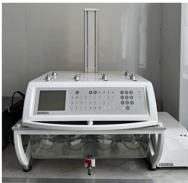
5-сурет – DT light таблеткалардың еру сынағына арналған аппараты (ERWEKA, Германия)
