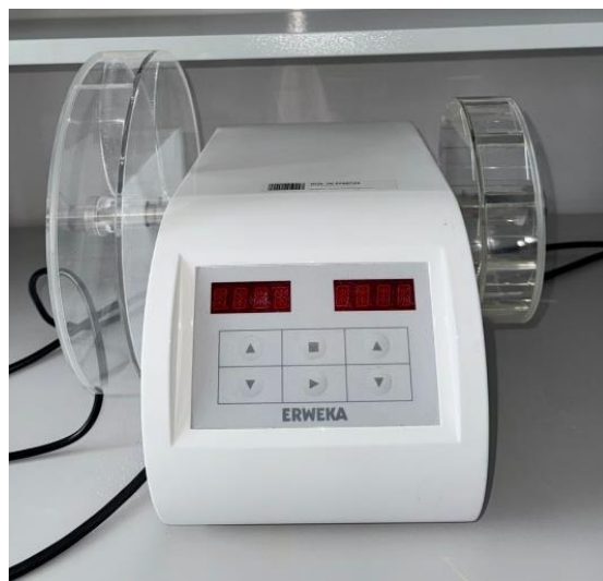
8-сурет – TAR II сериялы таблеткалардың үйкеліс төзімділігін анықтайтын аппарат (ERWEKA, Германия)
