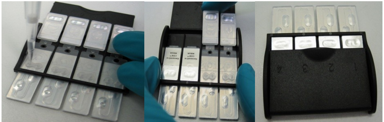
Рисунок 2- Прибор GenomEra CDX для определения специфической микробной ДНК S.difficile .
