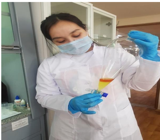
Сурет 6- Зерттелетін үлгіден дайындалған ерітіндіні экстракциялау кезеңі
