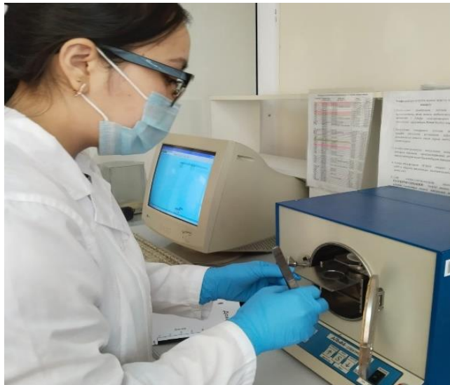
Сурет 7- Зерттелетін үлгілерді альфа-спектрометрде өлшеу барысы
