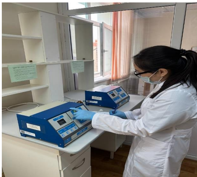
Сурет 4- Топырақ үлгілерін төмен фонды «УМФ-2000» альфа,-бета радиометрінде өлшеу
