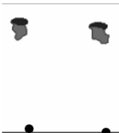
Рисунок 6 - Хроматография с использованием системы растворителей под номером 5 петролейный эфир- этилацетат (2:1).
