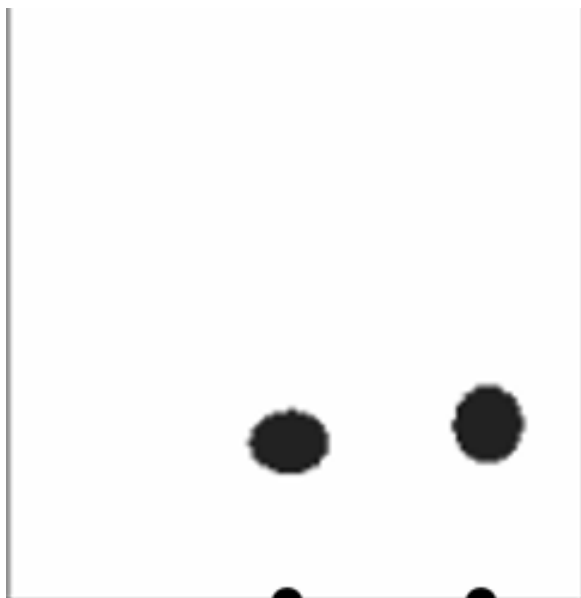
Рисунок 2 - Хроматография с использованием системы растворителей под номером 1 - бензол-этилацетат-кислота уксусная (50:50:1).
