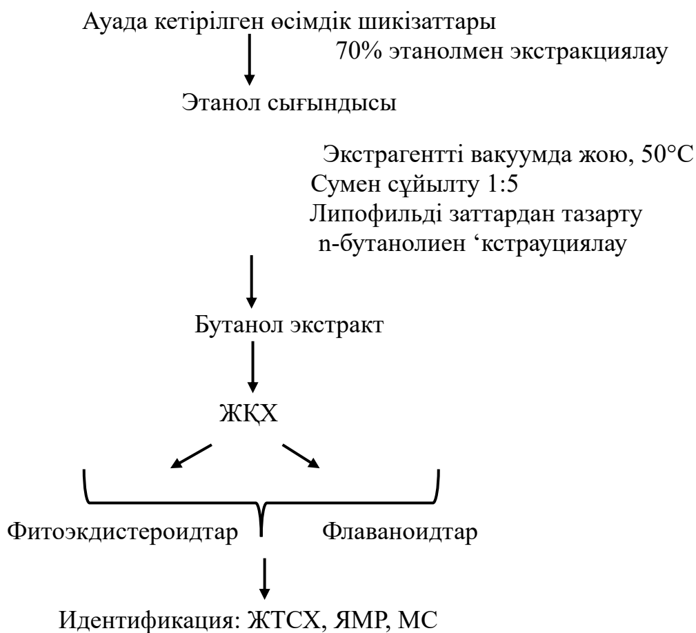
Сурет 14 - Өсімдік шикізатынан фитоэкдистероидтарды бөліп алу және тазарту схемасы
