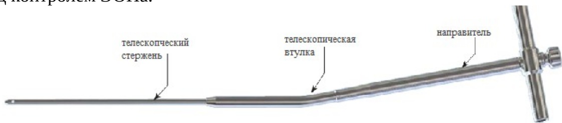
Рисунок 13 - Смонтированный телескопический фиксатор
