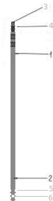
Рисунок 18 - Схема телескопического интрамедуллярного стержня для лечения деформаций нижних конечностей у детей с несовершенным остеогенезом
